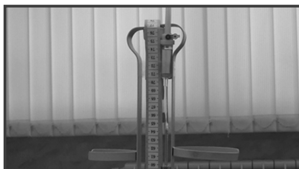
Рис. 7. Регистрируется начальный уровень жидкости в системе (~ 745 мм в. ст.)
